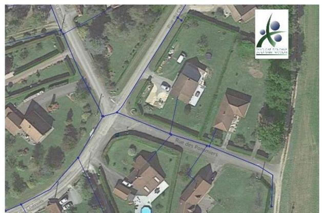
A partir des relevés, il fallait retracer manuellement sur le logiciel QGIS le tracé du réseau d'eau potable qui était complètement décalé par rapport à la réalité.
