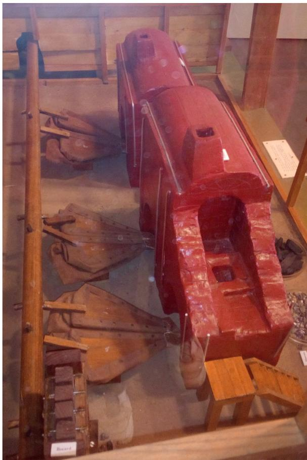
L'énergie hydraulique actionnait aussi les martinets des forgerons.
